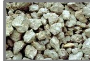
Agregados de Concreto Reciclado
