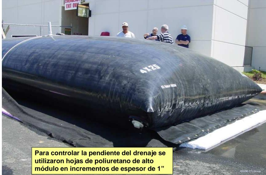
Para controlar la pendiente del drenaje se utilizaron hojas de poliuretano de alto módulo en incrementos de espesor de 1"
