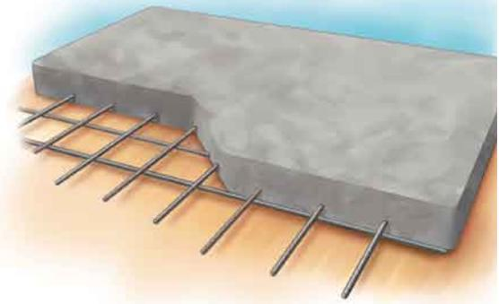
**E**l concreto hecho con cemento Portland tiene ciertas características: es relativamente resistente en compresión pero débil en tensión y tiende a ser frágil. La debilidad en tensión puede ser superada por el uso de refuerzo convencional de varilla y, en cierta medida, por la inclusión de un volumen suficiente de ciertas fibras.
