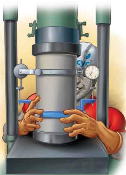
que los indicadores de los micrómetros no registren movimientos importantes. Si esto sucede será un indicativo de que los anillos no se fijaron adecuadamente, por lo habrá que desarmar y volver a montar el deformímetro o dispositivo de medición.
