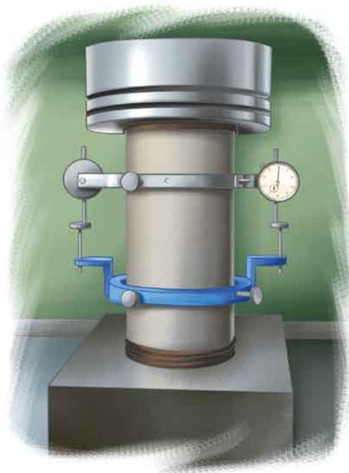
tido el concreto a esfuerzos de compresión dentro del comportamiento elástico. Es la pendiente de la secante definida por dos puntos de la curva del esfuerzo-deformación, dentro de esta zona elástica.
