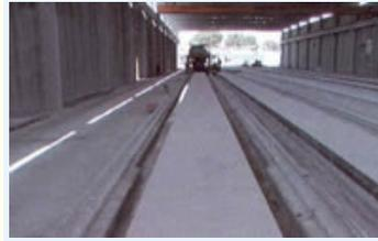
Las innovaciones en la fabricación y el montaje de losas prefabricadas con piso integral posibilitan tanto la disminución de las cargas en las estructuras, como en los costos y los plazos de ejecución.
