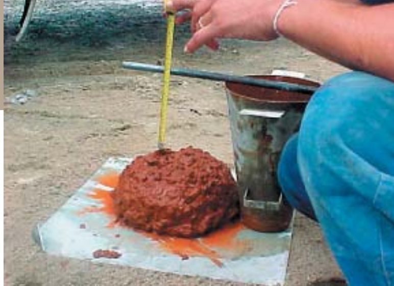
Fig. 4: Un revenimiento de entre 140 y 200 mm probó ser aceptable para lograr un HPCC trabajable
