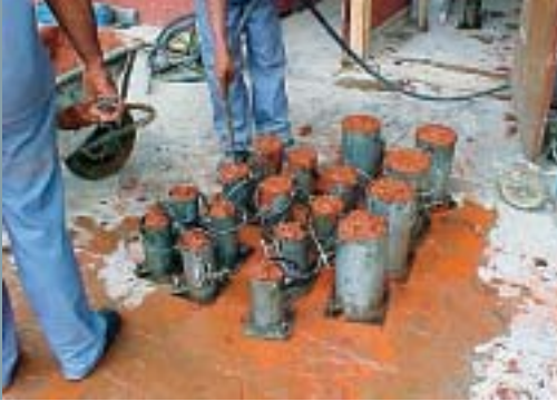
Fig. 6: Cilindros de prueba, de 100x200 mm y 150x300 mm, preparados en el sitio.
