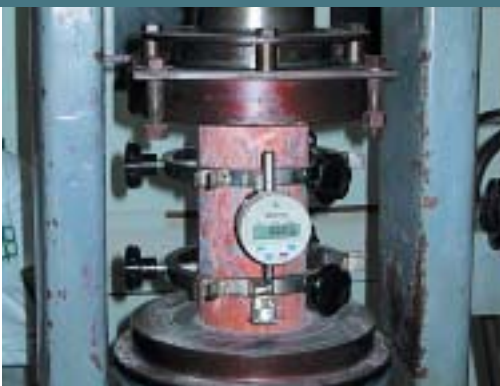
Fig. 7: Módulo de elasticidad a 28 días probado a 47.7 GPa con una desviación estándar 4.2 GPa y una variación estándar de 8.7%.
