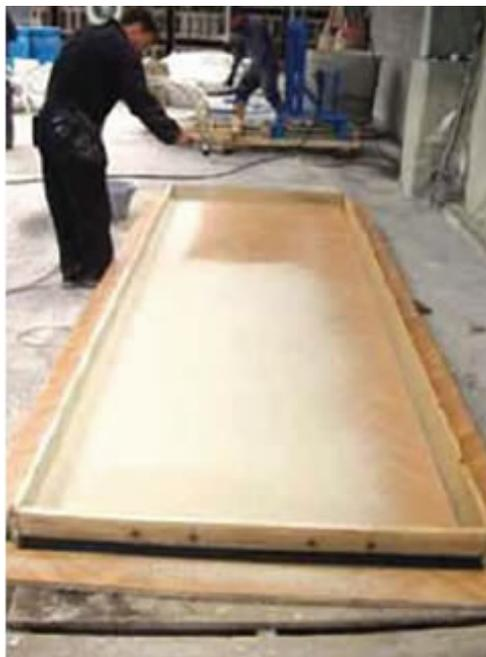
Acerca de la composición del producto, el GRC es un concreto muy rico en cemento, amasado con granulometrías finas de cuarzo (óxido de silicio) en proporción 1:1 y una dosificación de fibra de vidrio comprendida entre el 3% (sobre el peso total de la mezcla) si se añade precortada en la masa, hasta el 5% si se amalgama mediante proyección simultánea de la fibra y el concreto (procedimiento sprayed).
