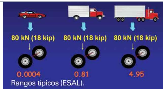
medad no se sustituye alta permeabilidad por estabilidad. Acerca del tráfico, deben considerarse los datos de entrada principales para el diseño de pavimentos, factores clave, tipos de ejes, carga de ejes, uso en el diseño y los datos del espectro de carga de ejes ESALs (equivalentes a la carga de eje sencillo).
