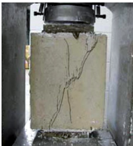
Fig. 8: Espécimen de 229 mm de ancho después del fallo.
