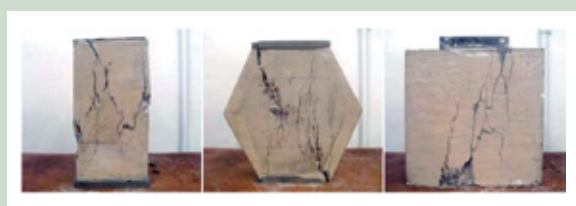
Fig. 5: Fallo típico en los especímenes de la Serie 1.
