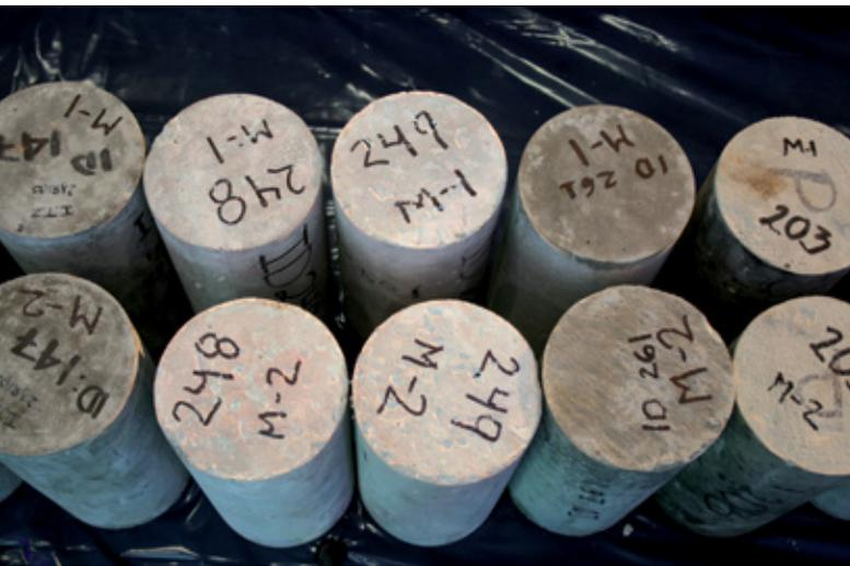
Cilindros de concreto, en espera de pasar la prueba.
