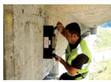
Escaneo con MIRA en viga post-tensada.
