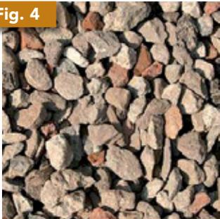
Agregados Reciclados de Concreto.
