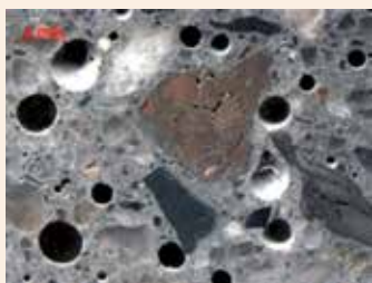
Petrografía contenido de aire en el concreto en estado endurecido (Cortesía Laura Powers, 2014).
