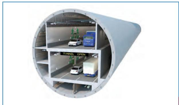
Esquema de la sección transversal del nuevo túnel.
