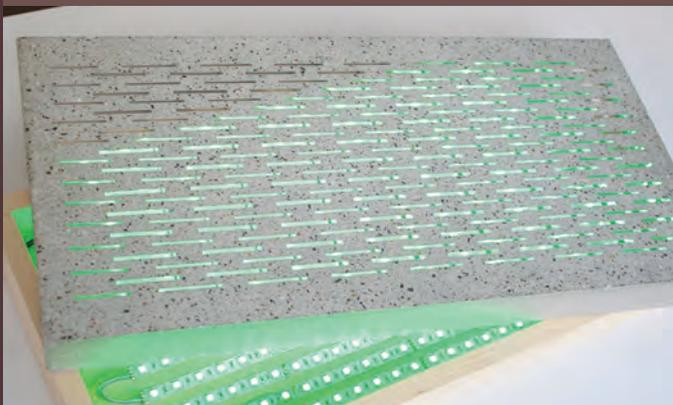
➤ *Pruebas del concreto traslúcido con LED.*
