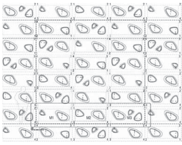
Figura 4: Esquema de disposición de los elementos de la fachada occidental.
