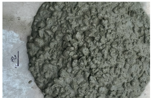
➤ Mezcla SCC con un flujo de 50 cm el cual se mantiene durante 45 minutos.
