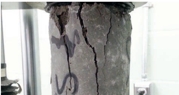
➤ Testigo de concreto convencional sometido a ensayo de compresión luego de someterlo a ciclos de hielo deshielo durante 3 semanas. Foto: Cortesía mymason.
