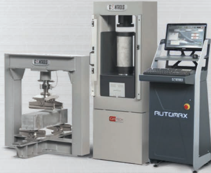
50-C20E82 AUTOMAX E-Modulus controlando un bastidor de compresión ASTM DE 2,00 kN 50-C46Z00 y un bastidor de flexión 50-C1201/BFR de 100 kN con accesorios.
