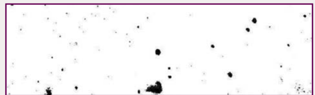
Figura 3: Análisis de imagen - Cálculo de la fracción de burbujas - Píxeles negros versus píxeles blancos. aparición de burbujas en la superficie.
