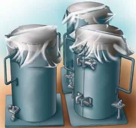
Empiece las pruebas de temperatura, revenimiento y contenido de aire dentro de los 5 minutos siguientes a la obtención de la porción final de la muestra compuesta. Inicie el moldeo de los cilindros dentro de los 15 minutos siguientes a la preparación de la muestra compuesta.
