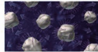
(b) Acción de los aditivos reductores de agua de alto riesgo
