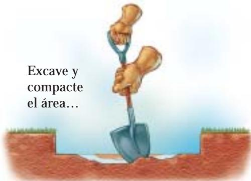
Siempre excave un área más grande que la necesaria para permitir la colocación de las cimbras. Trate de mantener las orillas y las esquinas perpendiculares.
