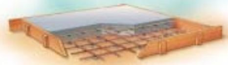
**LOCALIZACIÓN DEL REFUERZO.** Puede usarse refuerzo para incrementar la resistencia a flexión del concreto y/o para ayudar a controlar el agrietamiento.
