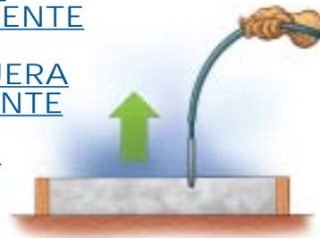
El **TAMAÑO** del vibrador determina cuánto concreto es vibrado cada vez.
