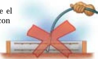
**NUNCA** extiende o mueva el concreto hacia los lados con el vibrador, puede provocar sangrado o segregación. Use siempre una pala.
