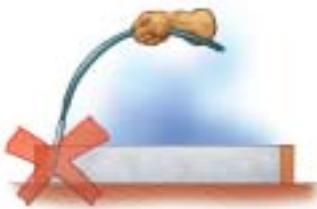
**NUNCA** toque el acero de refuerzo con el vibrador
