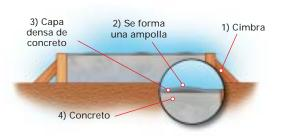
Causas Son causadas cuando la superficie de concreto fresco es sellada por medio del allanado mientras queda aire atrapado o agua de sangrado por debajo de la superficie. Esto puede ocurrir particularmente en losas gruesas o en días calientes y con viento, cuando la superficie está propensa a un secado rápido.
