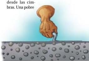
mezcla de concreto sin suficiente agregado fino que causa una mezcla rocosa.
