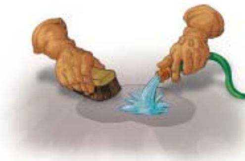
cmo durante el día para remover cualquier aceite o grasa que se haya introducido profundamente. Restriegue con agua caliente y detergente para lavar ropa y después enjuague con agua limpia al final del tratamiento.
