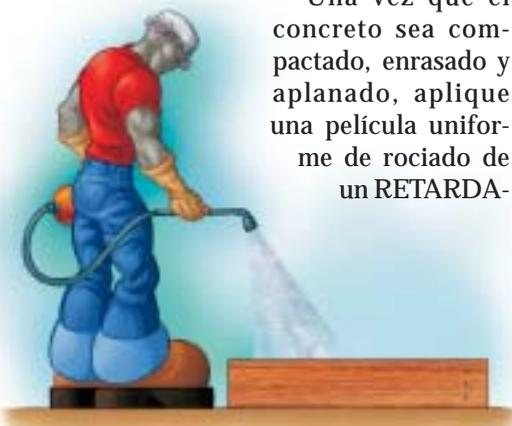
**DOR DE EVAPORACIÓN** (alcohol alifático) para evitar la pérdida rápida de humedad en la superficie, y luego continúe con el acabado.
