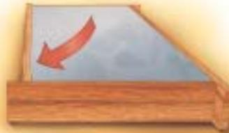
Si el concreto se colapsa, refuerce la cimbra y vuelva a vibrar el concreto.
