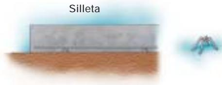
**Recubrimiento de concreto** El refuerzo debe ser colado de modo que haya suficiente concreto cubriéndolo para protegerlo contra la oxidación.
